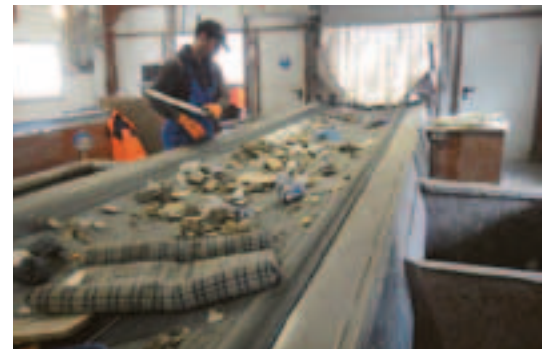
Die AVB GmbH & Co. KG nutzt Förderbänder für den internen Transport der Baustoff-, Misch- und mineralischen Abfälle.
