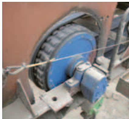
Profilierte Ummantelungen sorgen für sichere Bandmitnahme.
