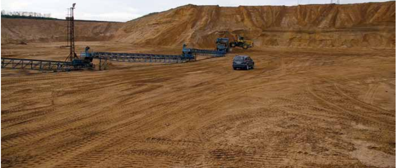
SCHON AN DER ABBAUFRONT endet die Arbeit der Radlader. Die wesentliche Transportarbeit obliegt diversen Bandanlagen.
