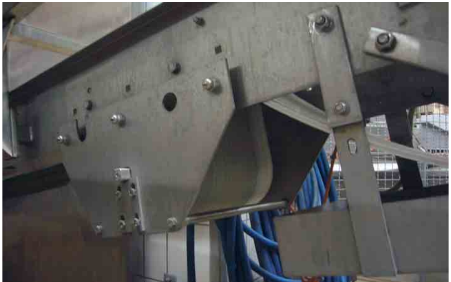
Vierkant-Achsenden ermöglichen eine spielfreie Befestigung der Trommelmotoren im Bandgerüst
